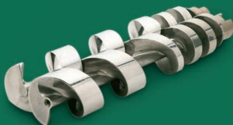
Il cuore delle nostre insaccatrici è la doppia vite VEMAG. Muovono gentilmente il preparato, anche di elevata granulometria, senza zone di compressione, dall'imbocco della tramoggia fino all'uscita della macchina. La materia prima non è stressata e l'emulsione impedita per un risultato appetitoso. Le doppie viti sono praticamente esenti da usura e quindi manutenzione. Smontaggio
